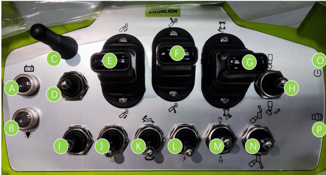
Figura 2-28 Panel de operación del control remoto
