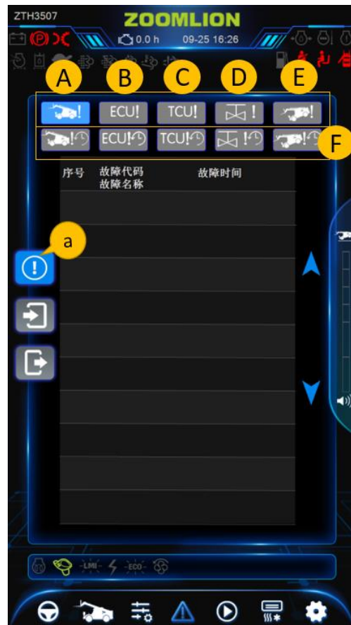
Figura 2-17 Interfaz de monitoreo de falla
