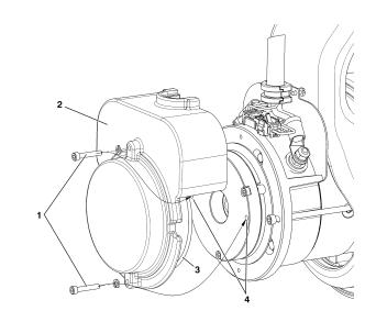
Figure 4-5. Manual Disengage
