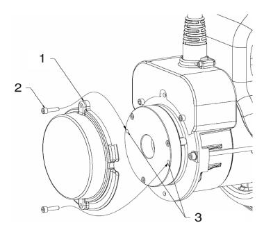
Figure 4-6. Manual Disengage
